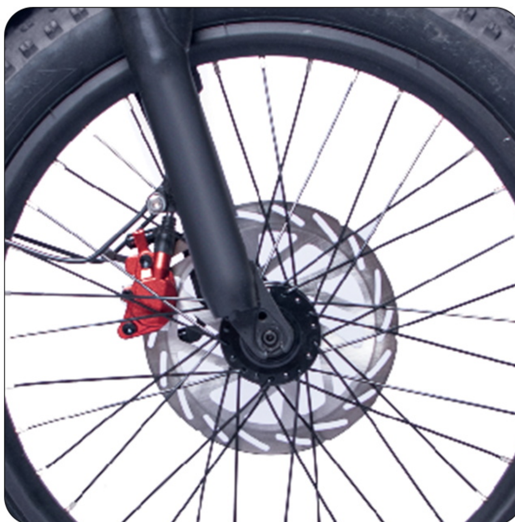
8. Namontujte přední kolo, věnujte pozornost otvorům v kole a přední vidlici, stejně jako vůli pro přední brzdu a brzdové destičky.
