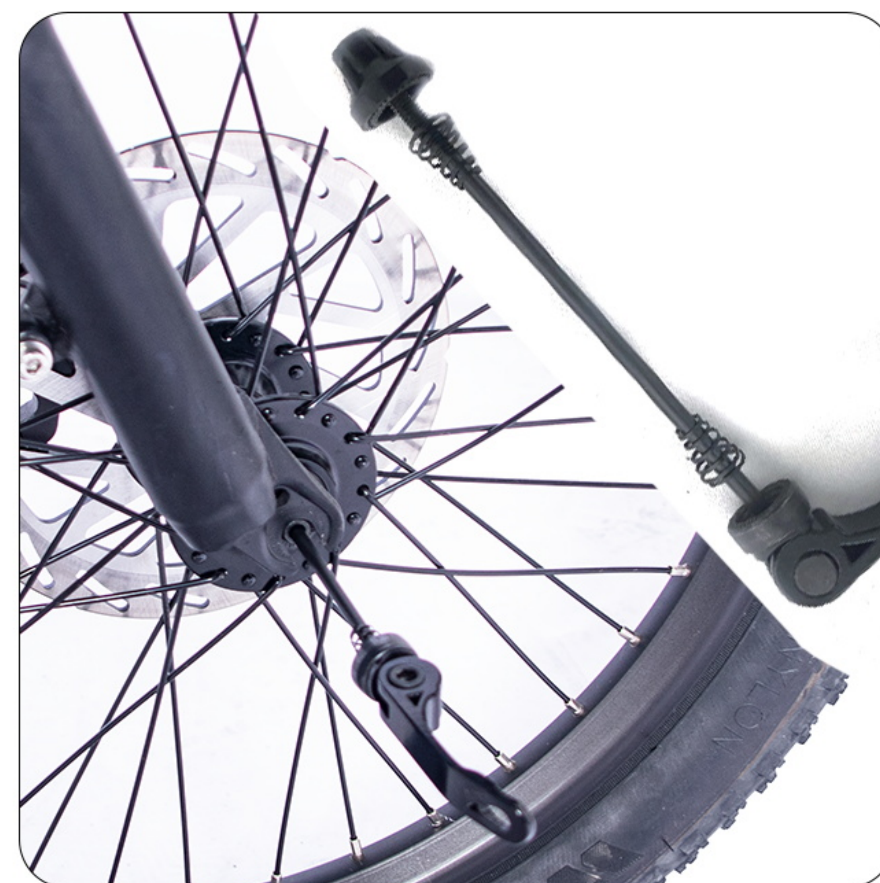
9. Namontujte rychloupínací osu předního kola podle obrázku, se dvěma kužellovými pružinami, po jedné na každé straně, s menší stranou směřující dovnitř. Nakonec osu rychloupínání utáhněte.
