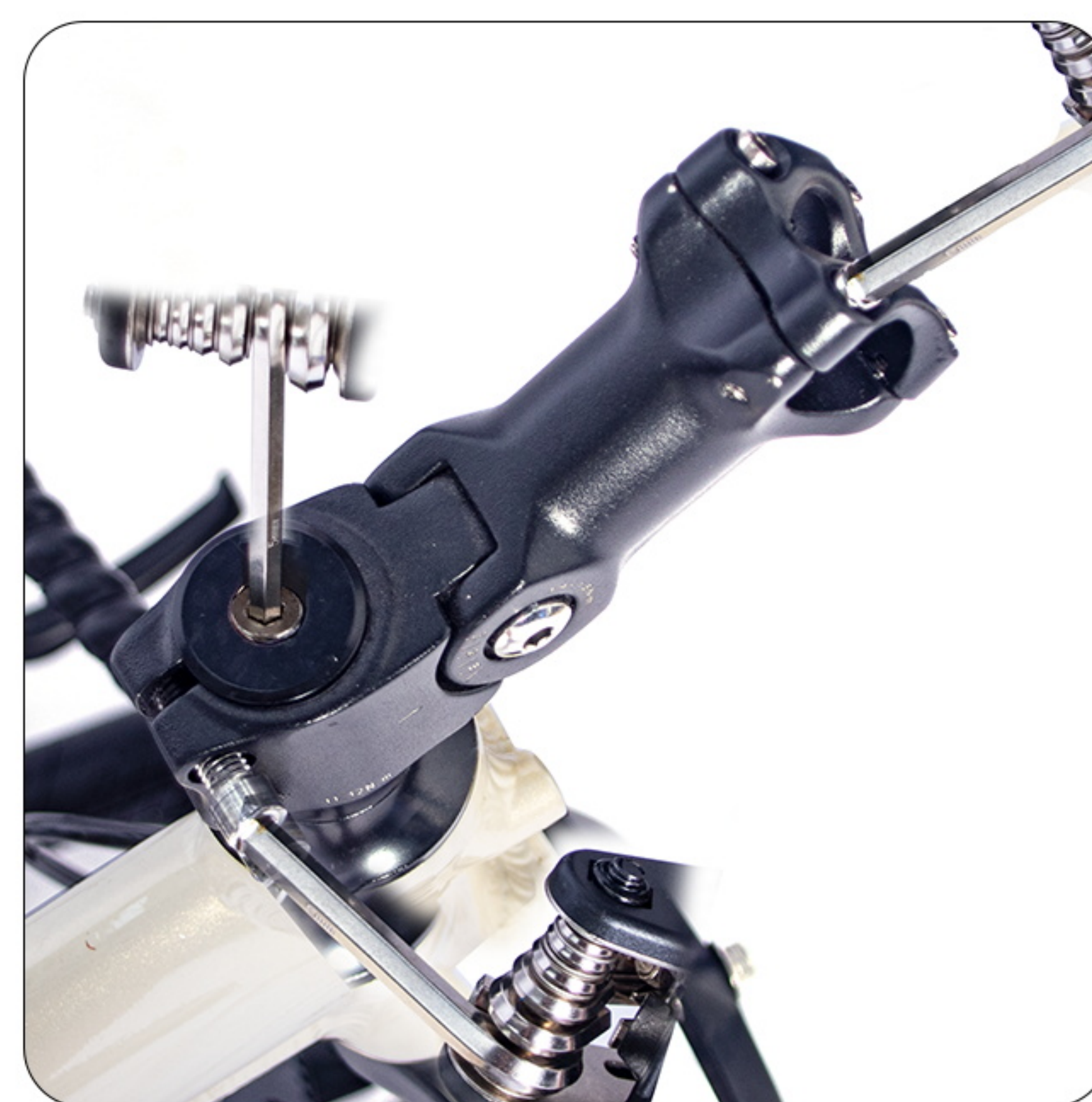
3. Nastavte představec směrem vpřed a zajistěte šrouby imbusovým klíčem. Použijte imbusový klíč k odstranění čtyř šroubů
