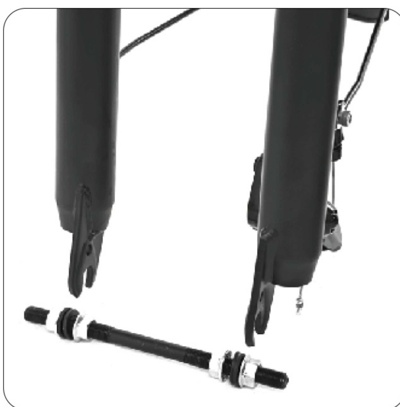
5. Odstraňte přední upínací klip, poté odstraňte ochrannou tyč přední vidlice a ochrannou podložku brzdy.
