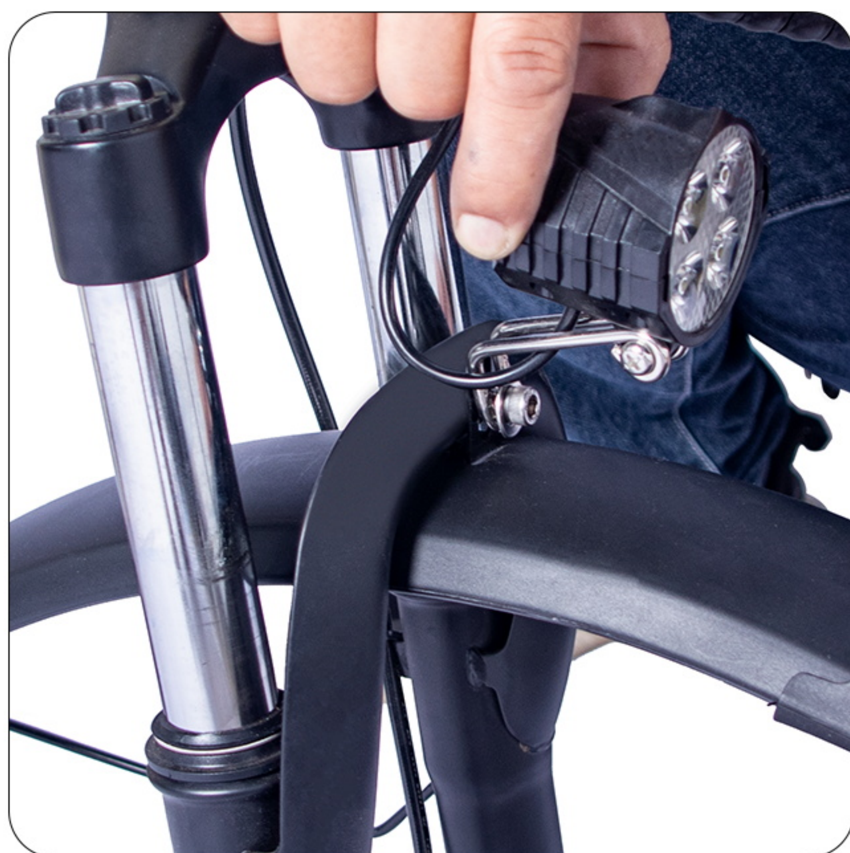
7. Namontujte světlo a držáky blatníku na přední vidlici podle pořadí na obrázcích.
