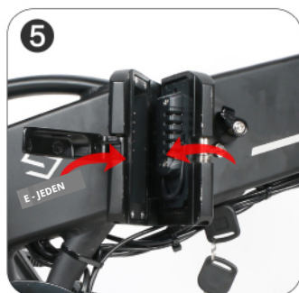
Vložte klíč do otvoru zámku, otočte po směru hodinových ručiček pro zamknutí baterie a poté složte rám.
