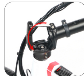
3 Postavit trubku nástavce svisle ve směru šípky a nainstalovat ji
