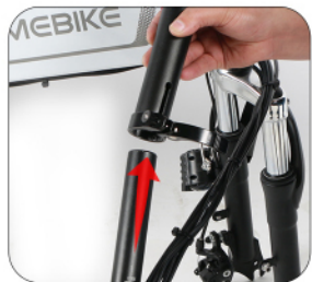
1 Povolit sponu stojanu a zasunout řídítka do stojanu
