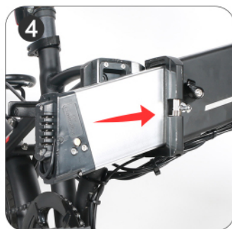
Rozložte elektrokolo podle směru. Vložte baterii do přihrádky s negativním pólem nahoře a pozitivním pólem dole.
