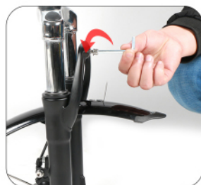
1 Povolit šrouby přední vidlice imbusovým klíčem
