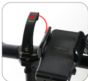
5 Povolit sponu řídítek a upravit úhel
