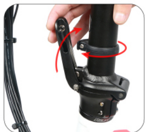
4 Utáhnout sponu stojanu ve směru šípky
