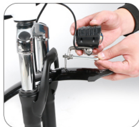
2 Vložte přední světlomety a přední blatník do šroubů a utáhněte je
