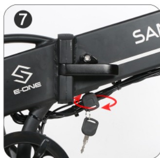
Chcete-li baterii odebrat, nejprve ji odemkněte podle příslušného směru. Při zapnutí vozidla je nutné klíčem otočit proti směru hodinových ručiček ve dvou polohách pro odemčení.
