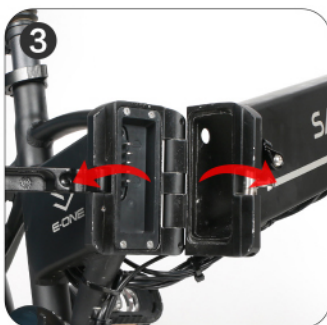
Rozložte elektrokolo podle směru. Vložte baterii do přihrádky s negativním pólem nahoře a pozitivním pólem dole.
