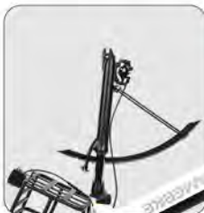
Otočte kolo vzhůru nohama pro snadnou montáž strany s elektromotorem. Montáž
