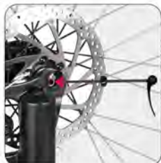
Vložte rychloupínací páku do náboje kola
