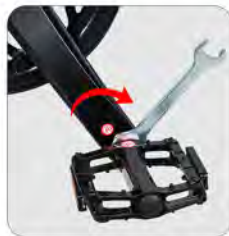
Pedál „R“ se montuje na pravou stranu převodníku, utahujte pedál „R“ ve směru hodinových ručiček. Pedál „L“ na opačné straně převodníku.
