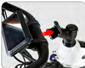
Namontujte řídítka pro nastavení směru
