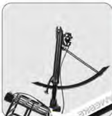
Nasadte světlomety a blatník – připravte přední pneumatiky. Otočte kolo pro usnadnění montáže
