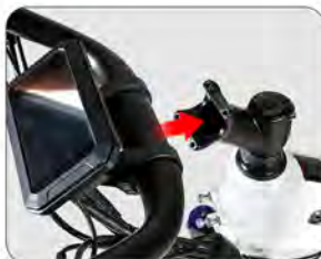
Namontujte řídítka pro nastavení směru jízdy
