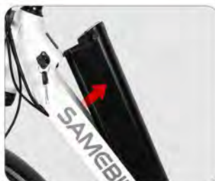
Vyjměte baterii směrem vzhůru.
