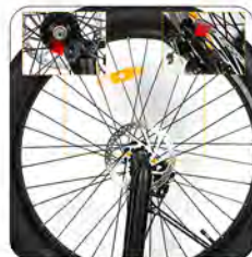
Nainstalujte stranu s kotoučem elektrického kola směrem ke ko- táčové brzdě
