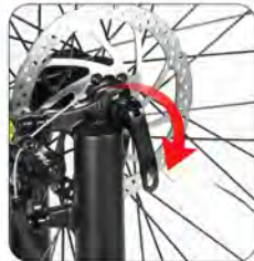
Uzamkněte páku rychlého uvolnění pro dokončení montáže předního kola
