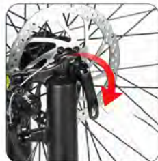
Uzamkněte rychloupínací páčku k dokončení montáže předního kola.
