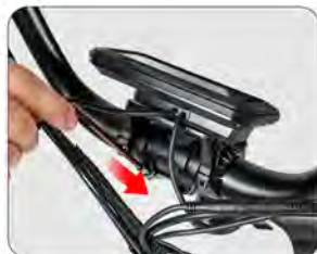
Utáhněte 4 šrouby k upevnění řídítek.
