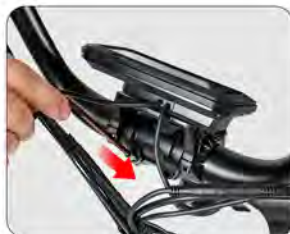
Utáhněte 4 šrouby k upevnění řídítek
