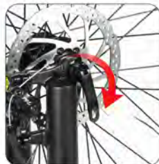
Zamkněte rukojeť rychloupínáku pro dokončení montáže předního kola.
