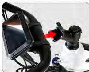
Namontujte řídítka pro nastavení směru jízdy
