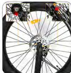
Nainstalujte stranu s elektrickou řemenicí směrem ke kotoučové brzdě
