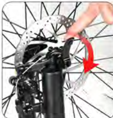
Po utažení s vhodnou silou upevněte rukojeť rychlou- pínací páky ve směru šipky
