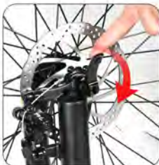
Po dotažení s přiměřenou silou zajistěte rychloupínací páčku ve směru šipky
