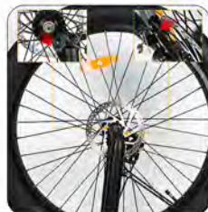
Nainstalujte stranu s kotoučem na elektrickém kole ve směru kotoučové brzdy.
