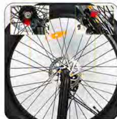
Namontujte stranu s kotoučem elektrického kola směrem k brzdě na kotouč
