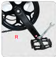
Pedál „R“ se montuje na pravou stranu převodníku, utahujte pedál „R“ ve směru hodinových ručiček. Pedál „L“ na opačné straně převodníku.
