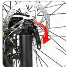
Zamkněte rukojeť rychlou- pínací páky k dokončení montáže před- ního kola
