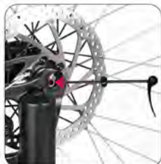
Umístěte rukojeť rychlou- pínací páky na pneumatiku
