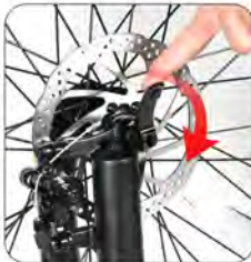
Po dotažení do určité míry. Zpevněte a upevněte páku rychlého uvolnění ve směru šípky
