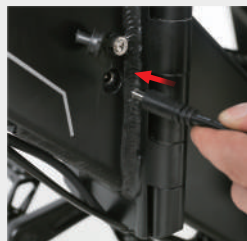
Metoda 1: Nabíjení elektrokola přímo ve směru určeném šipkou.
