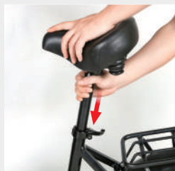
Zasuňte sedlovou trubku po nastavení správného směru a polohy výšky sedadla a zajistěte páčku rychloupínáku
