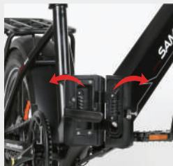
Přeložte elektrokolo na obě strany a složte jej.
