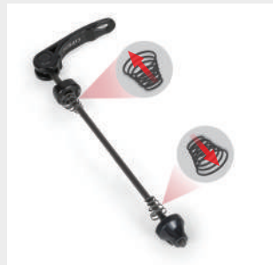
Vyjměte rychloupínací páku, věnujte pozornost směru pružiny.
