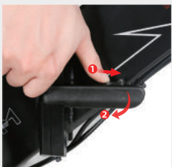
Otevřete svorky jednu po druhé v souladu s uvedeným směrem.
