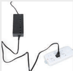
Připojte napájecí zdroj do zásuvky ; kontrolka signalizuje správné dokončení nabíjení.
