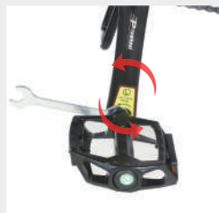
Utáhněte levý pedál označený "L" proti směru hodinových ručiček.
