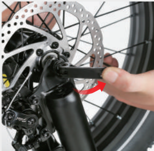
Pevně stiskněte rychloupínací svorku, aby byla zajištěna pevnost
