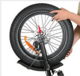
Odstraňte distanční podložku kotoučové brzdy
