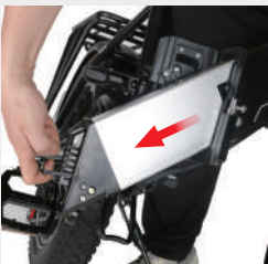
Vyměňte baterii v směru šipky
