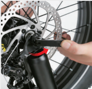
Silně přitiskněte rychloupínací svorku, aby byla bezpečně upevněna.
