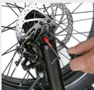
Vložte rychloupínací páku do drážky držáku předního kola
