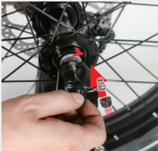
Upevněte rychloupínací mechanismus ve správném směru.
