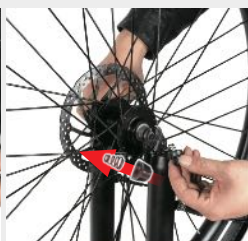
Installer les écrous à dégagement rapide sur le côté opposé de l'étrier.
