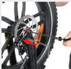
Umístěte rychloupínací sponu do slotu rychloupínání předního kola
