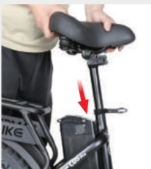
Vložte sedlovou trubku v souladu se směrem a nastavte výšku
