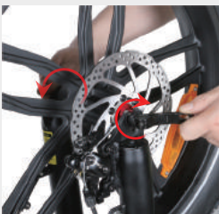
Utáhněte rychloupínání. Stiskněte rychloupínací sponu pevně, aby bylo zajištěno pevné upevnění
