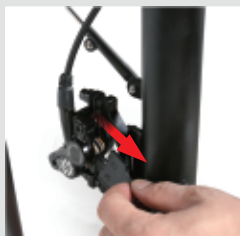
Odstraňte těsnění kotoučové brzdy. Vložte pneumatiku do vidlice
