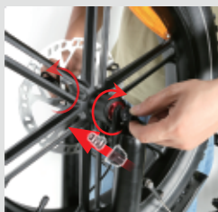
Utáhněte rychloupínací mechanismus. Stiskněte rychloupínací páčku pevně, aby byla zajištěna stabilita
